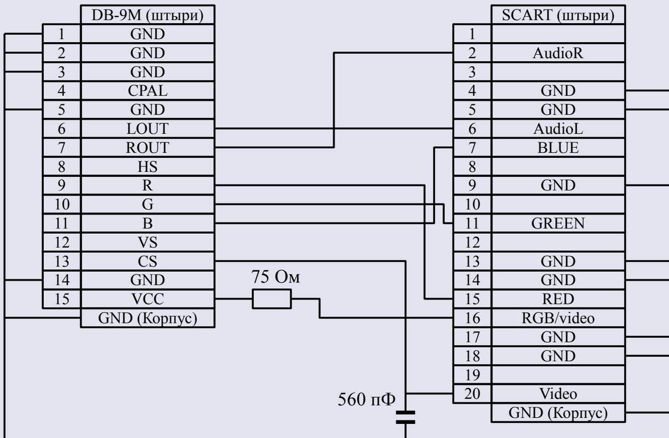
Схема подключения телевизора-монитора VESTEL к ZX-Evolution по интерфейсу SCART.
